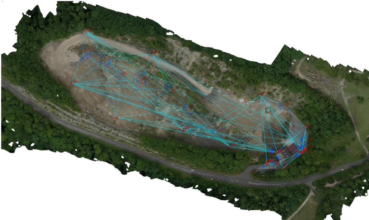
Abbildung 8: Lokales Netz mit Instrumentenstandpunkten
