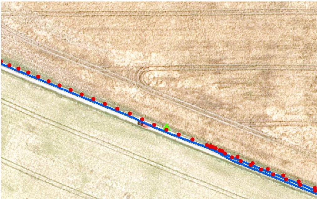
Abbildung 17: Vergleich von Echtzeittrajektorie (rot, 1s) und Ergebnis des Postprocessings (blau, 1m)
