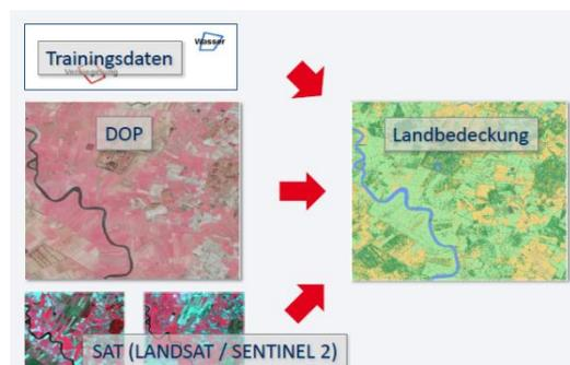
Fernerkundungsmodul und das Userinterface 2 (Nutzung Datenoutput). Die Eingangsdaten für die Landbedeckung sind die Trainingsdaten, Digitale Orthophotos und Satellitenbilder (LANDSAT/SENTINEL-2).
