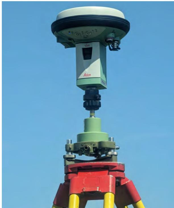
Abbildung 11: GNSS Empfänger
