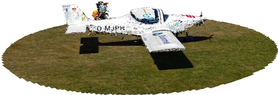
Abb. 2.4: Dichte Punktwolke von Bildern aus Phantom 4 (automatisch gesteuert)
