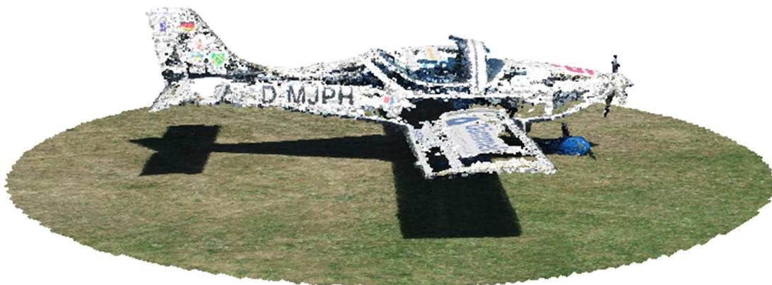
Abb. 2.3: Dichte Punktwolke von Bildern aus Phantom 4 RTK (manuell gesteuert)
