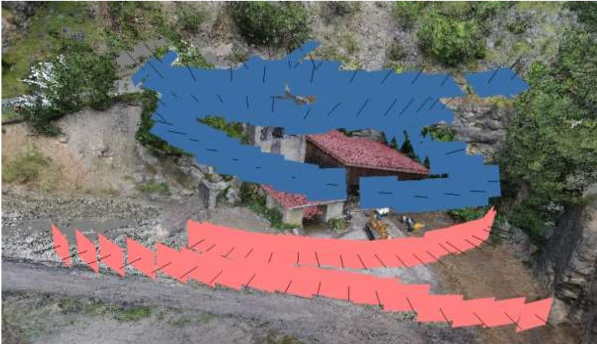
Abbildung 2.1 Die Standpositionen von Terrestrische Kamera and UAV
