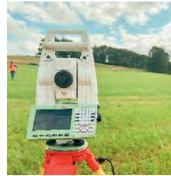
Nun wurde ein geodätisches 3D-Netzwerk mit Hilfe von Tachymetermessungen erstellt. Dieses dient später dazu weitere Punkte mit hoher Genauigkeit erfassen zu können.
