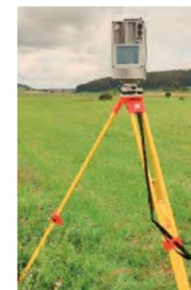
Das Gelände wurde außerdem mit einem Laserscanner (Leica HDS7000) von sechs Standpunkten aus gescannt. Die entstandenen Punktwolken wurden mit Hilfe der Software Leica Cyclone zusammengefügt. Daraus erfolgte die Erstellung eines digitalen Geländemodells und eines digitalen Oberflächenmodells.
