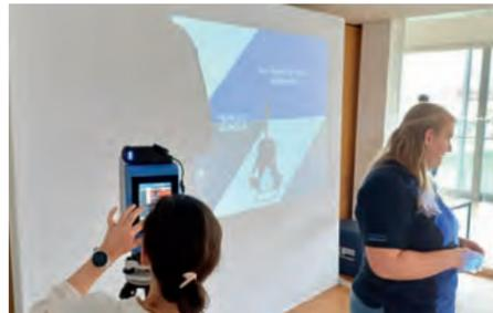
Anschließend wurde der FlexScan vorgestellt. Dies ist eine Mobile Mapping SLAM-Plattform. Sie bietet zwei Anschlüsse, um einen TLS zu montieren. Der FlexScan kann auf unterschiedliche Trägersysteme aufgesetzt werden. Dazu gehören z.B. Rucksäcke und Stativwagen. Das Rucksacksystem konnte direkt getestet werden.
