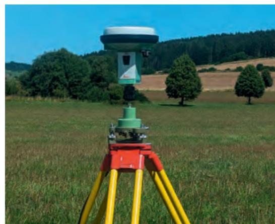
Nach Abschluss der ersten beiden Tage begann Arbeitspaket 2. Hier wurde eine geodätische Netzverdichtung durchgeführt, die mithilfe eines lokalen Tachymeternetzes in beiden Gebieten umgesetzt wurde. Die Verknüpfung mit dem GNSS-Netz erfolgte durch korrespondierende Punkte in beiden Bereichen. Diese Aufgabe dauerte ebenfalls zwei Tage, und damit war die erste Woche, die von viel Sonnenschein begleitet wurde, abgeschlossen.
