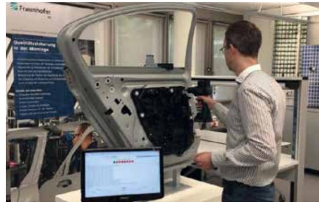
Tracking eines Akkuschraubers im Industrie 4.0 Lab, ©Fraunhofer IIS
