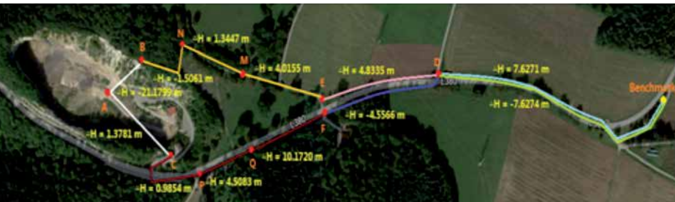
Schleifennivellement zwischen Deponie und Festpunkt
