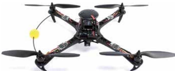
**Abbildung 1. Nahaufnahme einer XAircraft X450 Pro: Leichtbau bis ins kleinste Detail. Gut zu erkennen: die Bordelektronik inklusive GPS-Antenne. Die gelbe Kugel signalisiert die Hauptflugrichtung. Quelle: digitec.ch**
