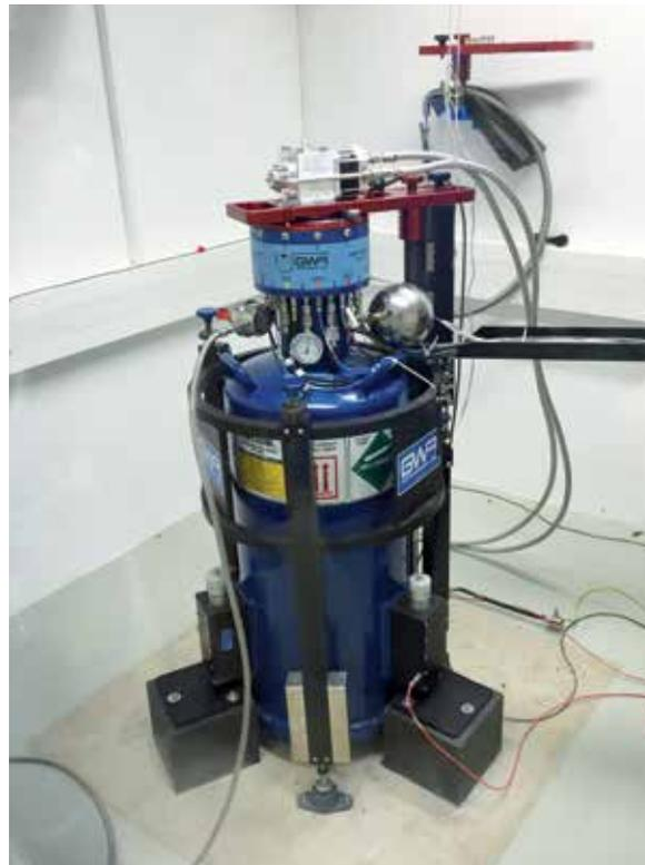
**Abbildung 14: das Supraleitende Gravimeter**
