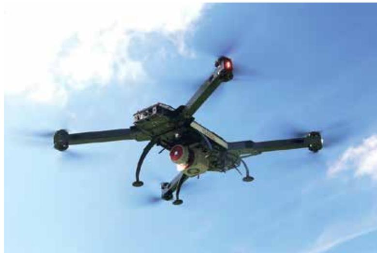
**Abbildung 4. Riegl RiCOPTER mit installiertem VUX-1 Laserscanner. Mit einer Flugdauer von über 30 Minuten bei maximaler Nutzlast von 16 kg ist der fast 2 m lange Octokopter für jeden Einsatz gerüstet. Quelle: RIEGL**
