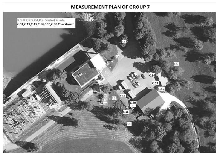
Abbildung 25: Skizze der verwendeten Koordinaten (Festpunkte und Checkerboards)
