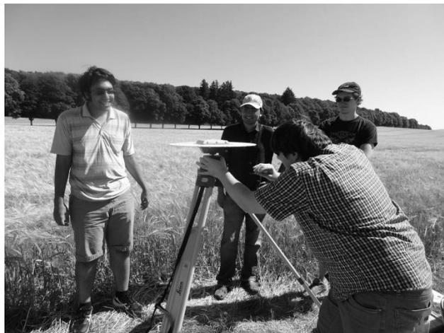
*Abbildung 13: Aufbau einer Referenzstation im Feld*
