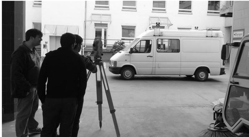
*Abbildung 11: Automatische Aufnahme von am Fahrzeug befestigten Reflektoren mit einem Robot-Tachymter*
