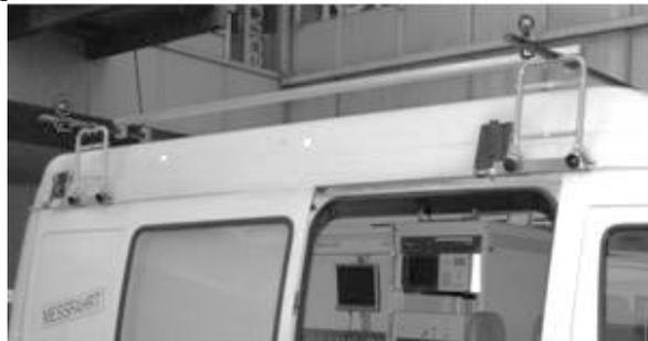
Abb. 5.11: Signalisierte Punkte an den GPS-Antennen
