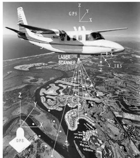
Abb. 1.2: Prinzip der Laserscan-Befliegung
