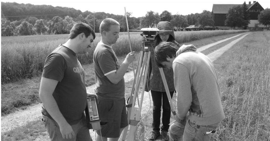
Abb. 7: Aufbau der Basisstation
