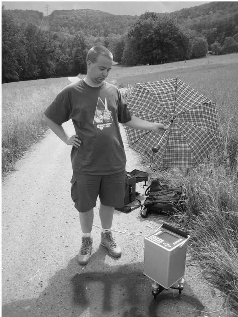
Abb. 3: Schweremessung mit Scintrex CG-5 Autograv
