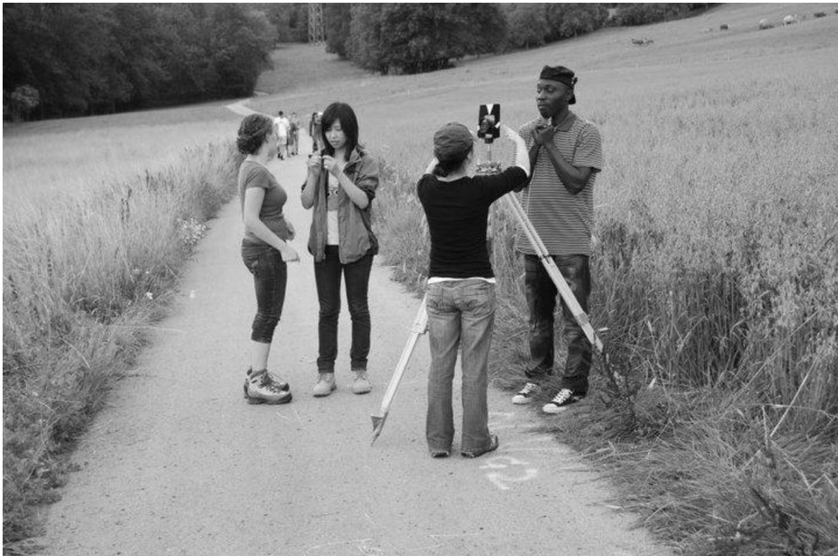
Abb. 9: Reflektorhorizontierung und -zentrierung
