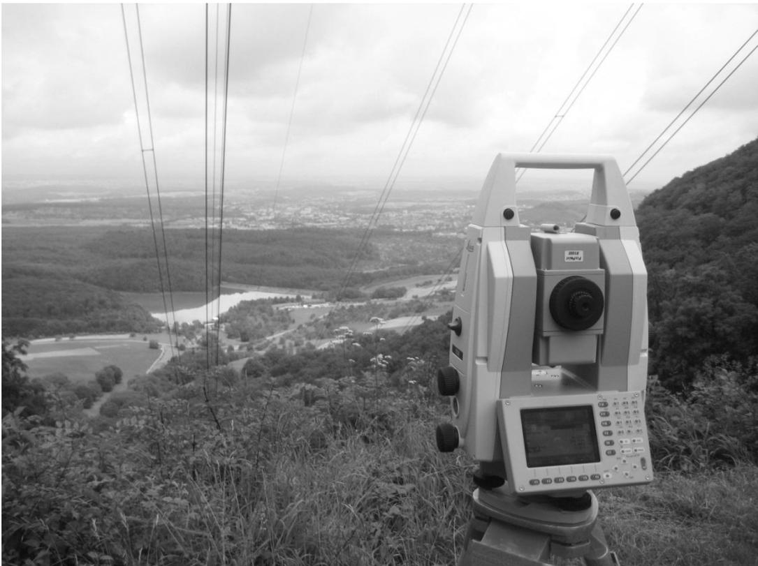
Abb. 4: Trigonometrische Höhenübertragung am oberen Anschlusspunkt E1
