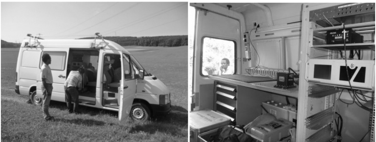
Abb. 5 – Messbus im Einsatz (links) und Innenausstattung inklusive IMU (right)
