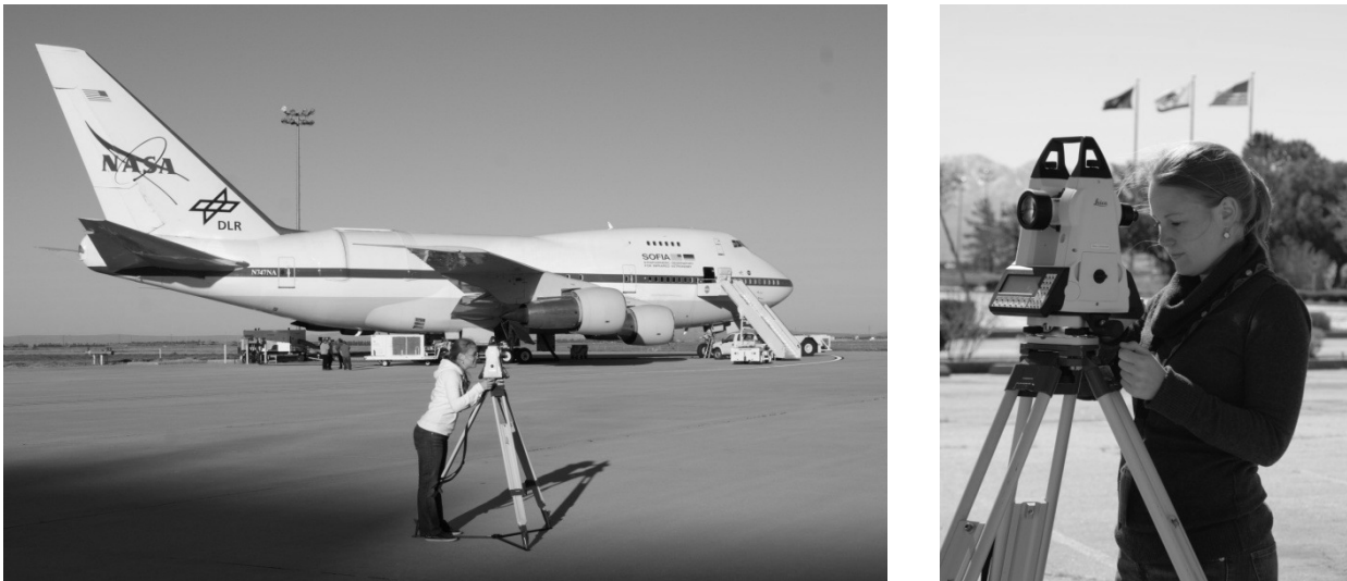
Abb. 5 Netzverdichtung mittels Theodolit
