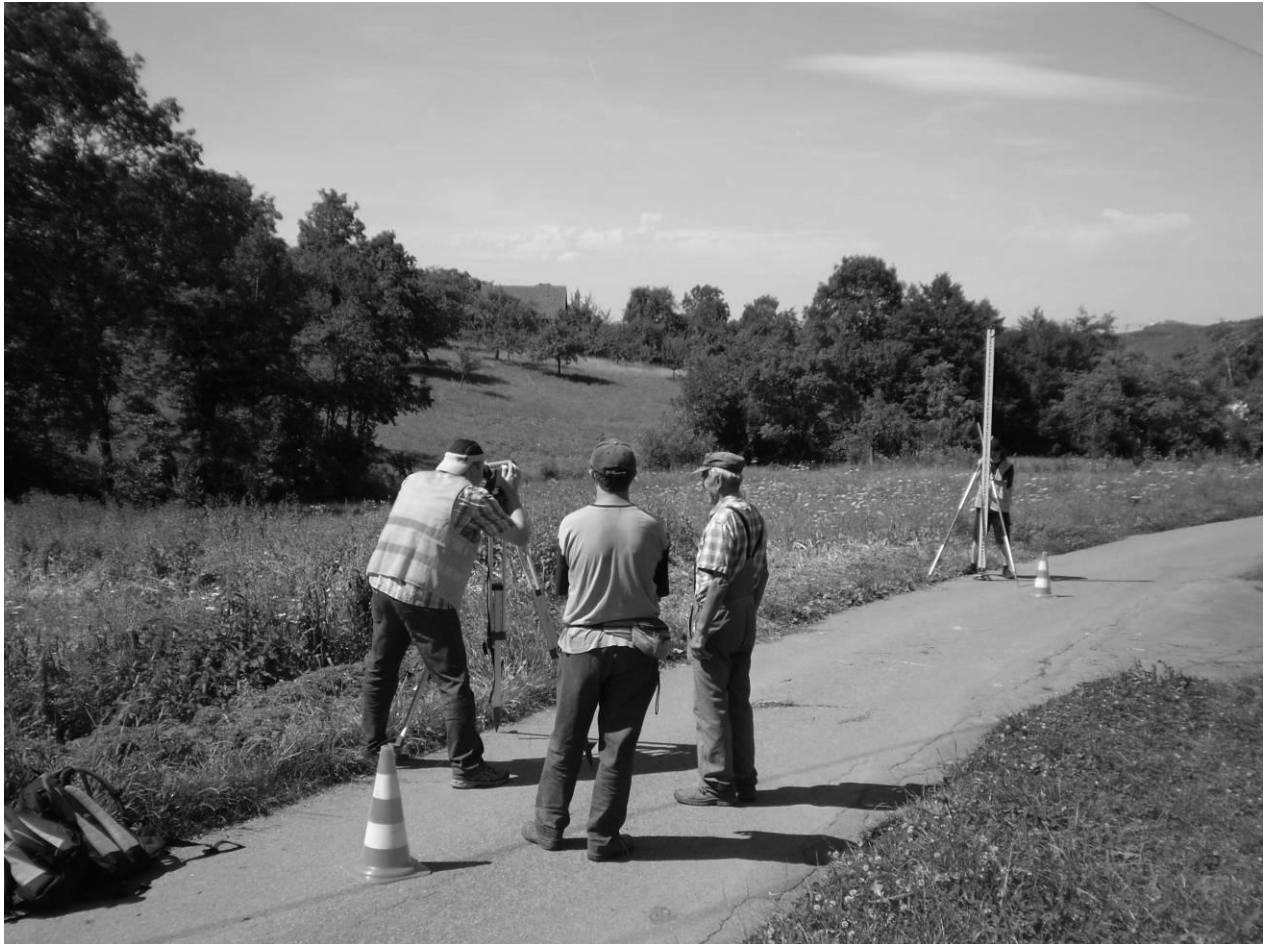
Abb. 4: Durchführung des Nivellements
