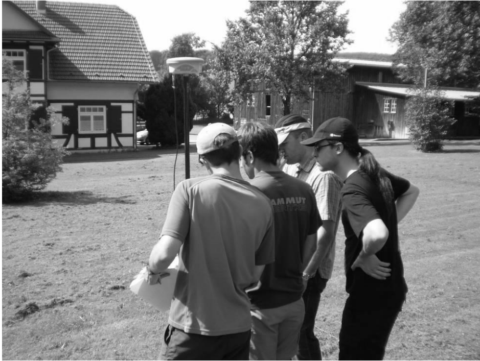
Abb. 11: Verdichtung des Grundlagenetzes mit GPS-RTK im Bereich des Albguts Lindenhof
