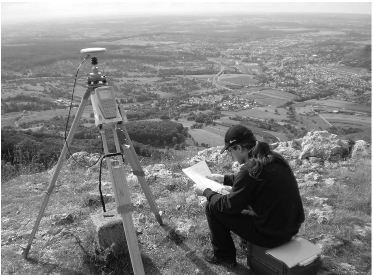
Abb. 3: Statische GPS Messung des Grundlagenetzes
