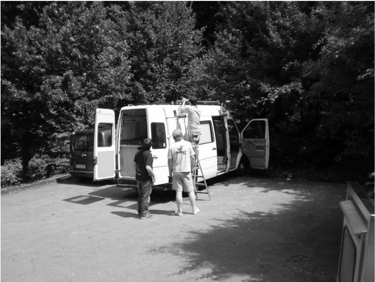
Abb. 10: Vorbereitung des Fahrzeug zur kinematischen GPS-Aufnahme der Zufahrtswege
