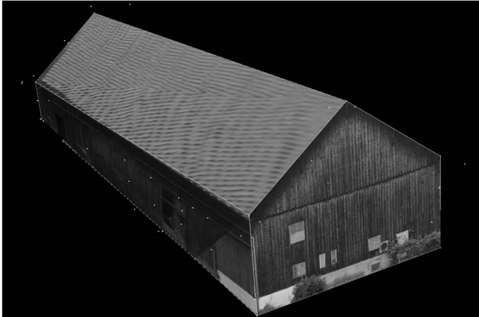
*Abb. 13: Mit PhotoModeler erstelltes 3D-Modell*
