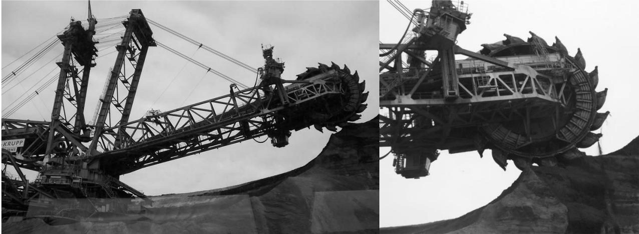
Hier werden täglich knapp eine Million m<sup>3</sup> Erdreich auf einer Fläche von 30 km<sup>2</sup> von 1725 Mitarbeitern abgetragen. Bei einem Verhältnis von Abraum zu Kohle von 5:1 macht das 200.000 m<sup>3</sup> Braunkohle am Tag. Dies ergibt im Jahr eine Förderung von 40 Millionen Tonnen. Von dieser immensen Menge werden 90% für die Stromerzeugung verwendet und die restlichen 10% zur Veredelung (Koks oder Kohlestaub).
