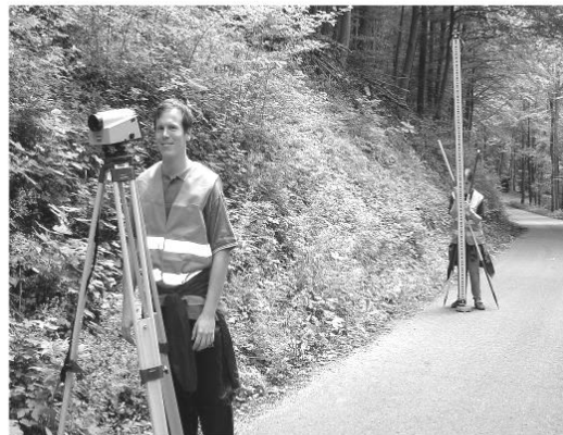
Abb. 6: Relativgravimetrie bei Regen Abb. 7: Feinnivellement mit dem Dini 1 von Leica
