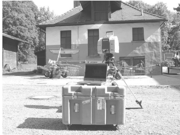
Abb. 15: Laserscanner mit Steuerungsnotebook
