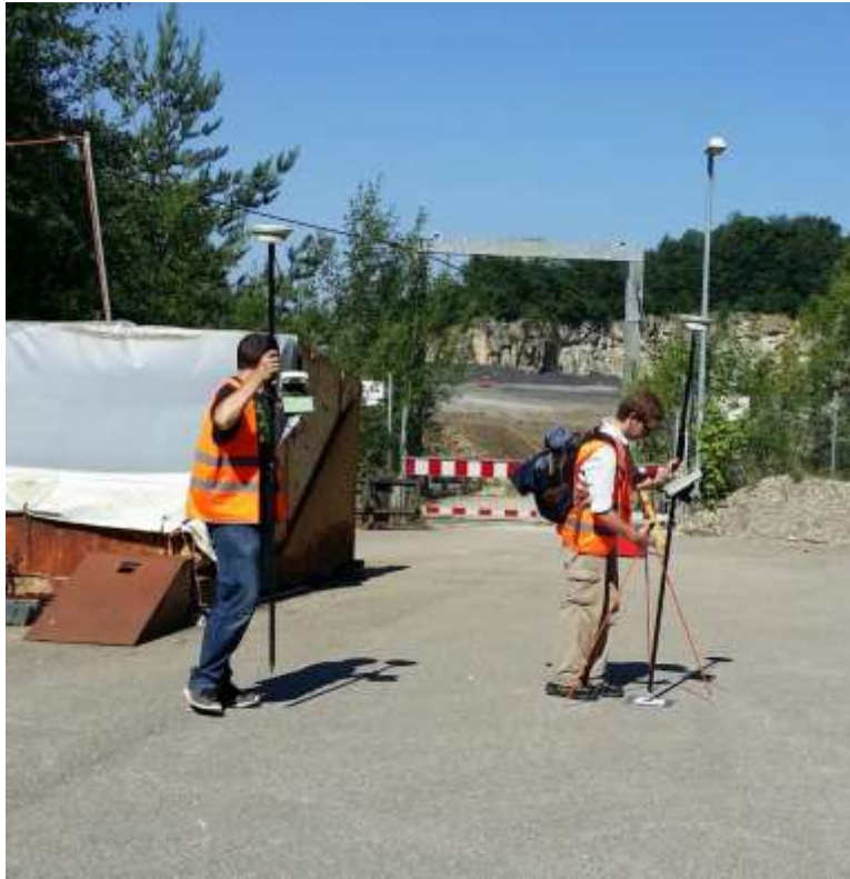
RTK-Messung mit zwei mobilen Antennen
